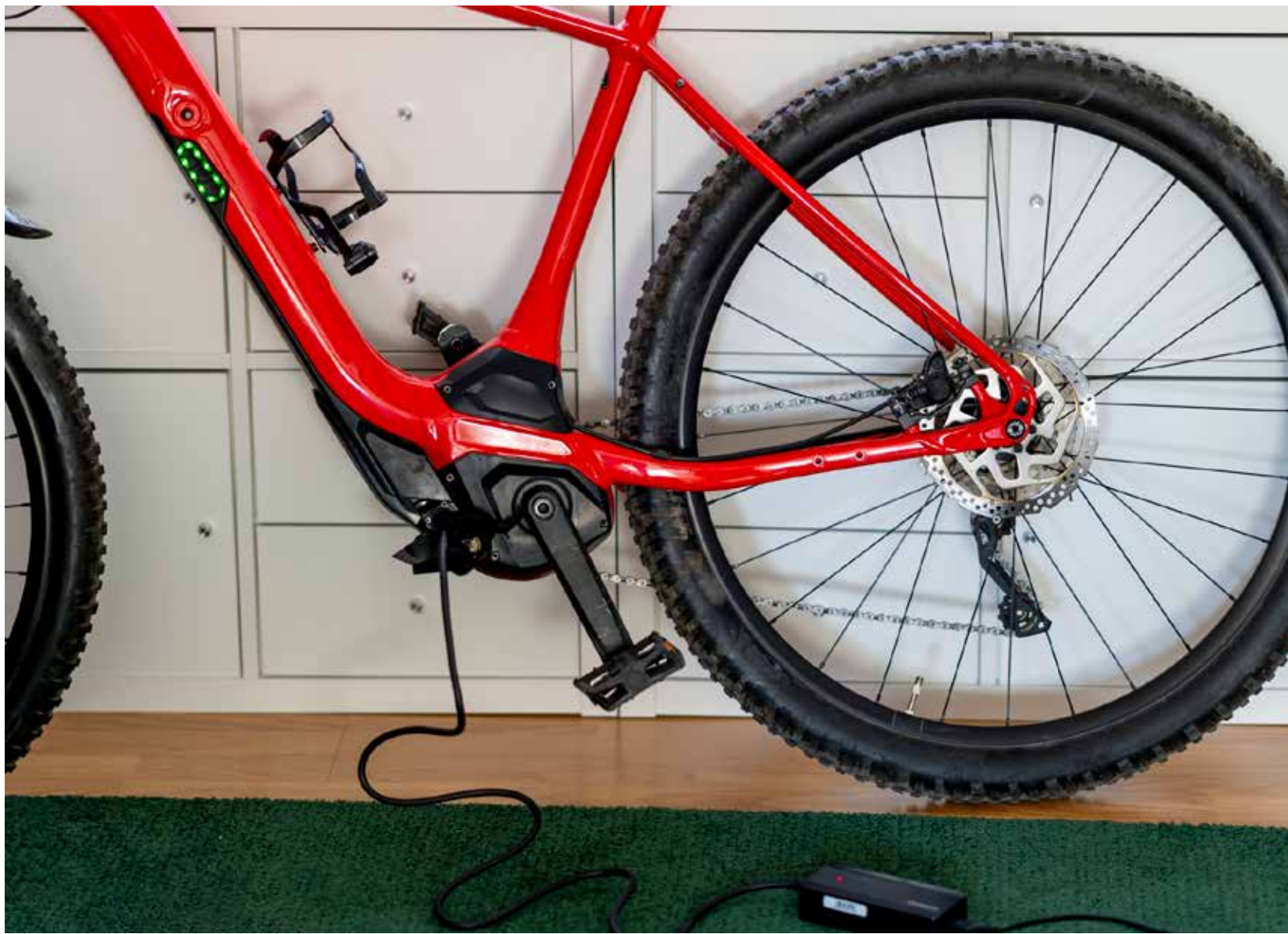
Laden Sie E-Bikes ausschliesslich mit dem Original-Ladegerät und nie unbeaufsichtigt.
