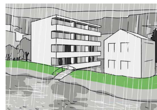
Ein Hochwasserschutzdamm schützt permanent
