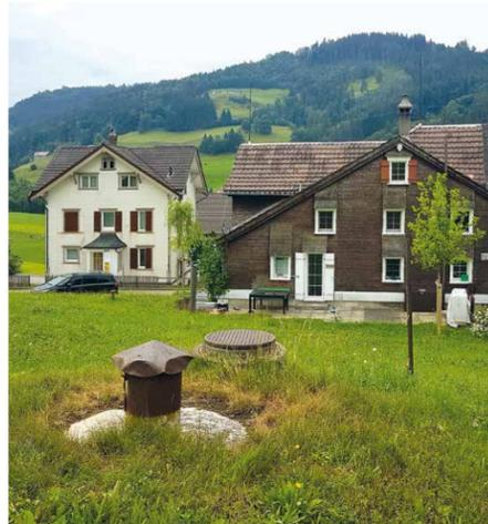
Geschlossener, unterirdischer Löschweizer mit Wasserentnahme über einen Schacht.
